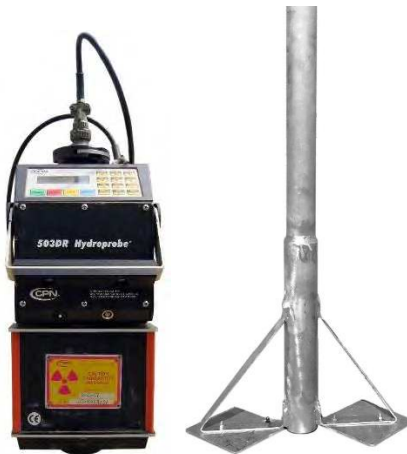
شکل ۲. کاوشگر نوترون و پایه‌ی کنترل عمق
