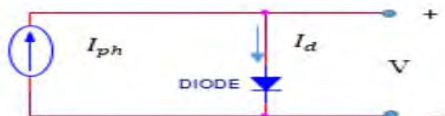
شکل (۱): مدار معادل ایده آل مدل تک دیودی سلول فتوولتائیک
