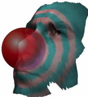
شکل 3: کانتورهای بدست آمده ناشی از تقاطع یک کره با سطح
