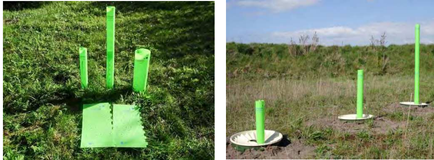
شکل ۶: ورقه‌های محافظ تلسکوپی و نمونه‌ی نصب شده‌ی آن
